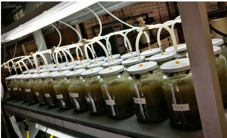
Abbildung 58: Versuchsaufbau in sogenannten Mikrokosmen. 1 Glas entspricht einem Replikat mit der freilebenden Meiofauna-Lebensgemeinschaft (Sediment aus der Lippe), welche durchgängig belüftet wurde.
