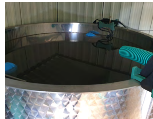
Edelstahl-Sammelbehälter (1.000 L) für große Probenvolumen bei Regenwetter, um ausreichend Mikroplastik zu gewinnen.
