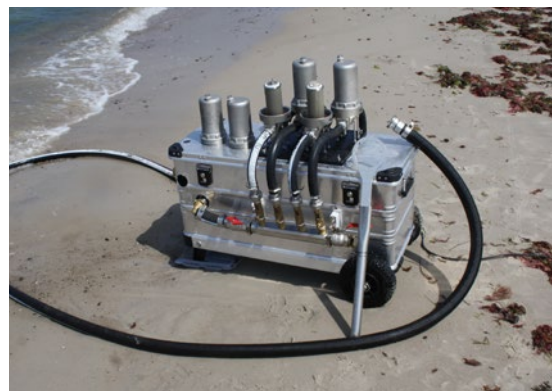
Abb. 3: Das eigens für die Mikroplastik Probenahme entwickelte Gerät ‚Rocket‘ bei einer Testprobenahme an der Ostsee.
