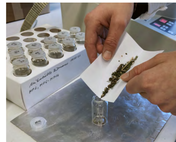
Vor der Bestimmung des Mikroplastik-Gehaltes wird das Seesediment in Partikel-Größenklassen aufgeteilt.
