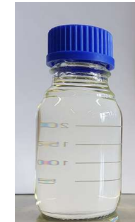
Styrolöl-Kondensat aus EPS-Abfall nach Destillation mittels Vigreux-Kolonne
