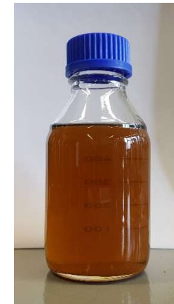
Styrolöl-Kondensat gewonnen mittels Depolymerisation einer EPS-Abfall Probe am IKV
