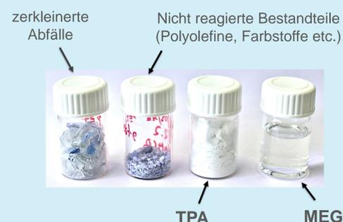
Abb. 4: Ausgangsmaterial und Produkte einer Machbarkeitsstudie in Labormaßstab
