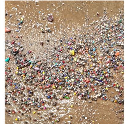
Abb. 1: Pellet-Verluste auf Betriebsgelände eines Kunststoffproduzenten
