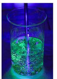
Abb. 8: Homogen verteilte, fluoreszierende PE-Partikel
