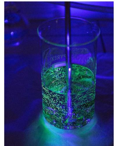
Abb. 2 Fluoreszierende MPP im Rührversuch
