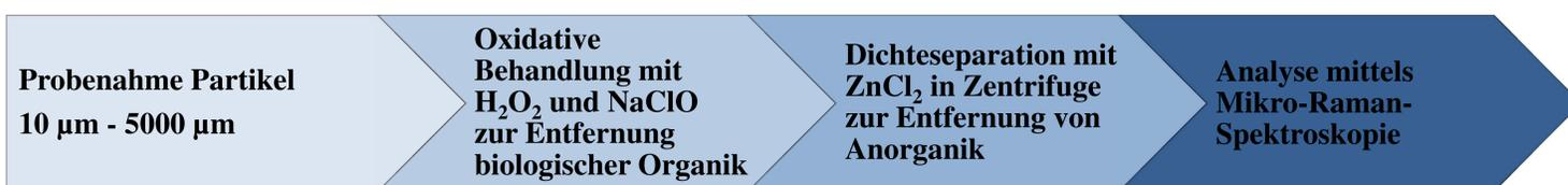
Abb. 1 Probenaufbereitungs- und Analyseverfahren
