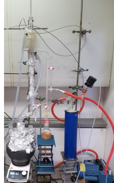
Abb: Vakuumdestillation mit Füllkörperkolonne
