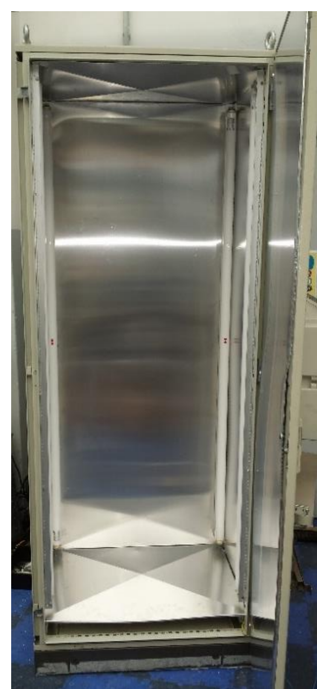
Klimaschrank zur Alterung von Folien
