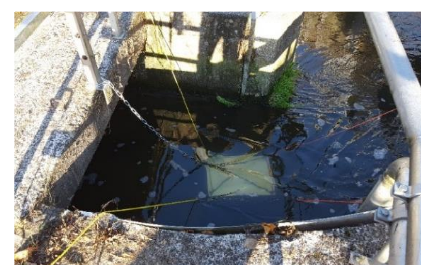
Sedimentationskasten schwebend in Wassersäule zur passiven Probenahme (Klarlauf von Kläranlage Kaiserslautern)
