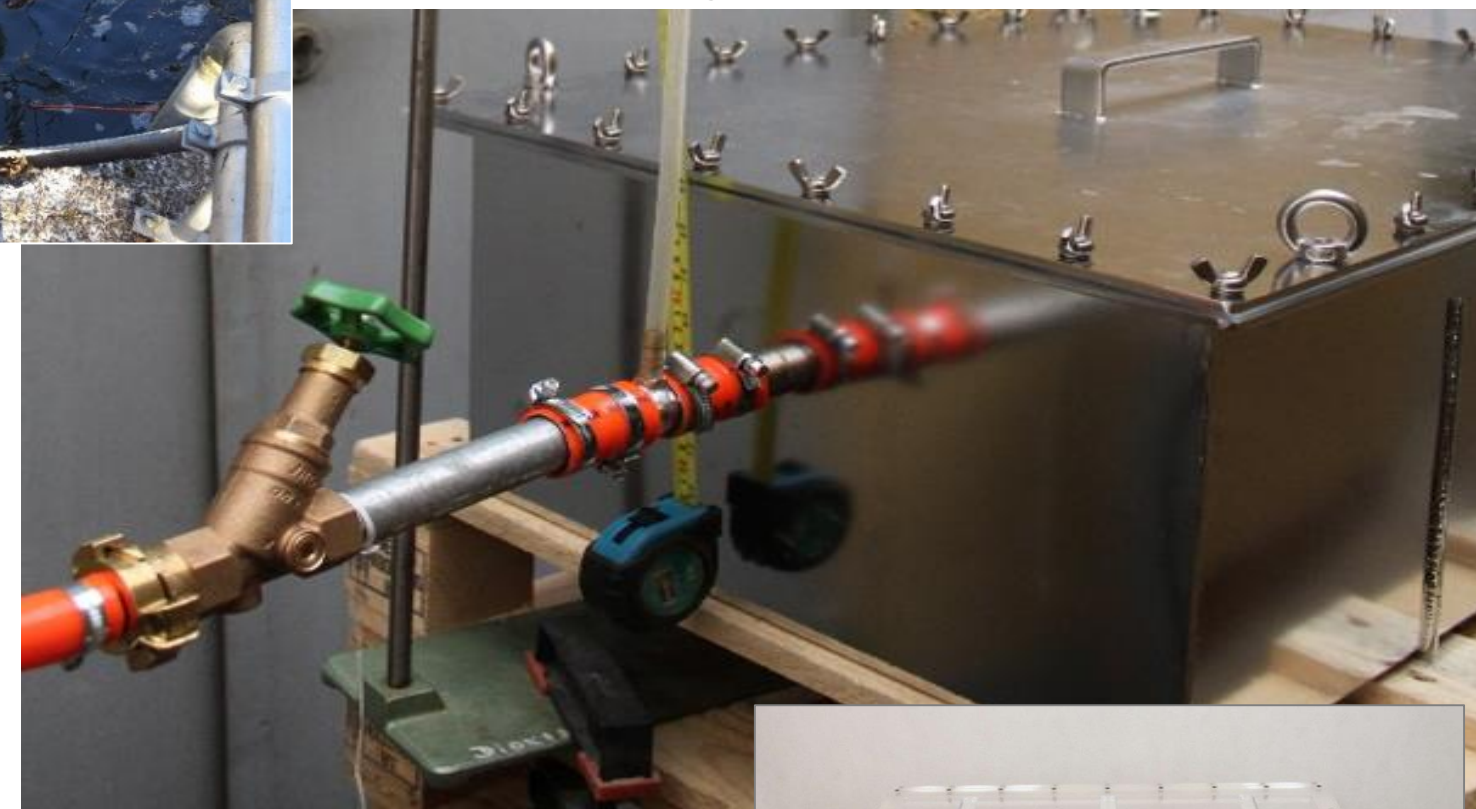
Sedimentationskasten im Labortest Anschluss an Pumpe und Druckmessvorrichtung
