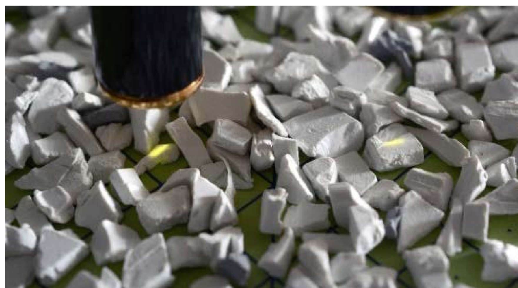
Abb. 2: Fluoreszenz-Effekt bei Kunststoff-Mahlgut
